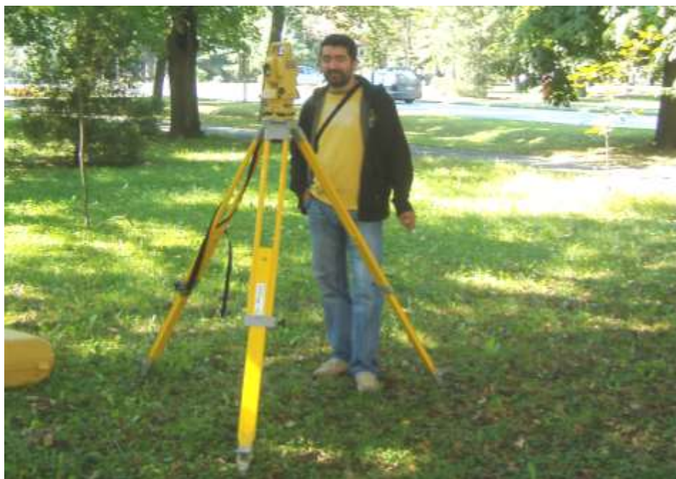
Сл. 7. Геометар са инструментом тотална станица Sokkia Series 30 R (Кораћ Ј., 2015)
